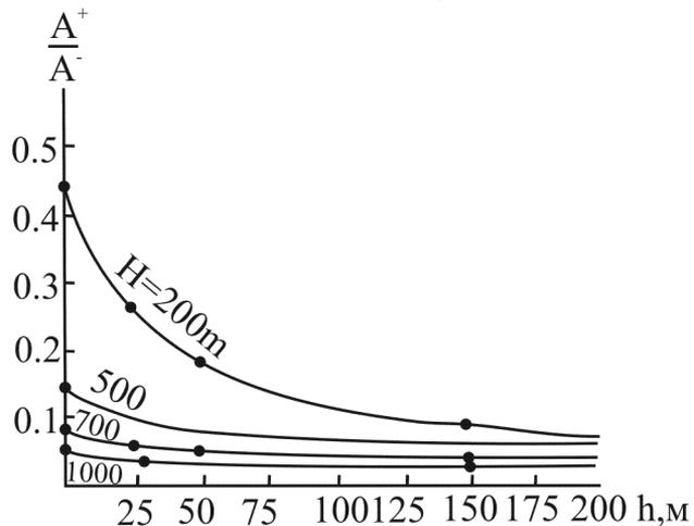
Рис.7.3. Зависимость параметров  $A$ ,  $A^+$ ,  $A^-$ ,  $A^+/A^-$  от мощности немагнитного покрова  $h$  для различных вертикальных мощностей цилиндра  $H$  (по Г. Б. Романовскому).
