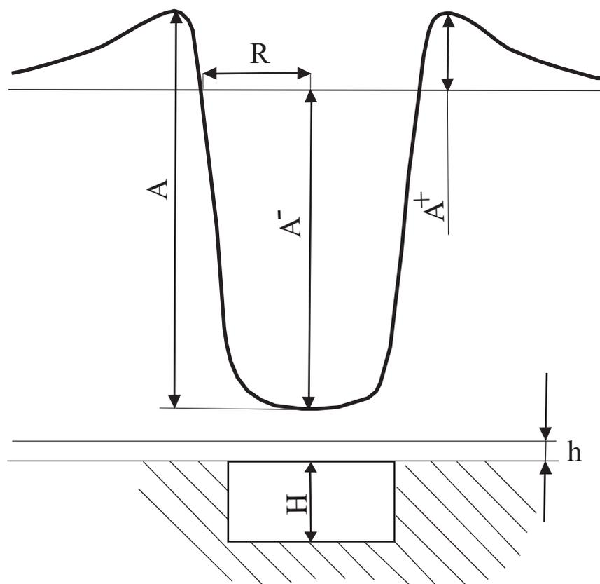
**Рис.7.1. Кривая  $Z$  над вертикальным эллиптическим цилиндром при вертикальном намагничивании (по Г.Б.Романовскому)**
