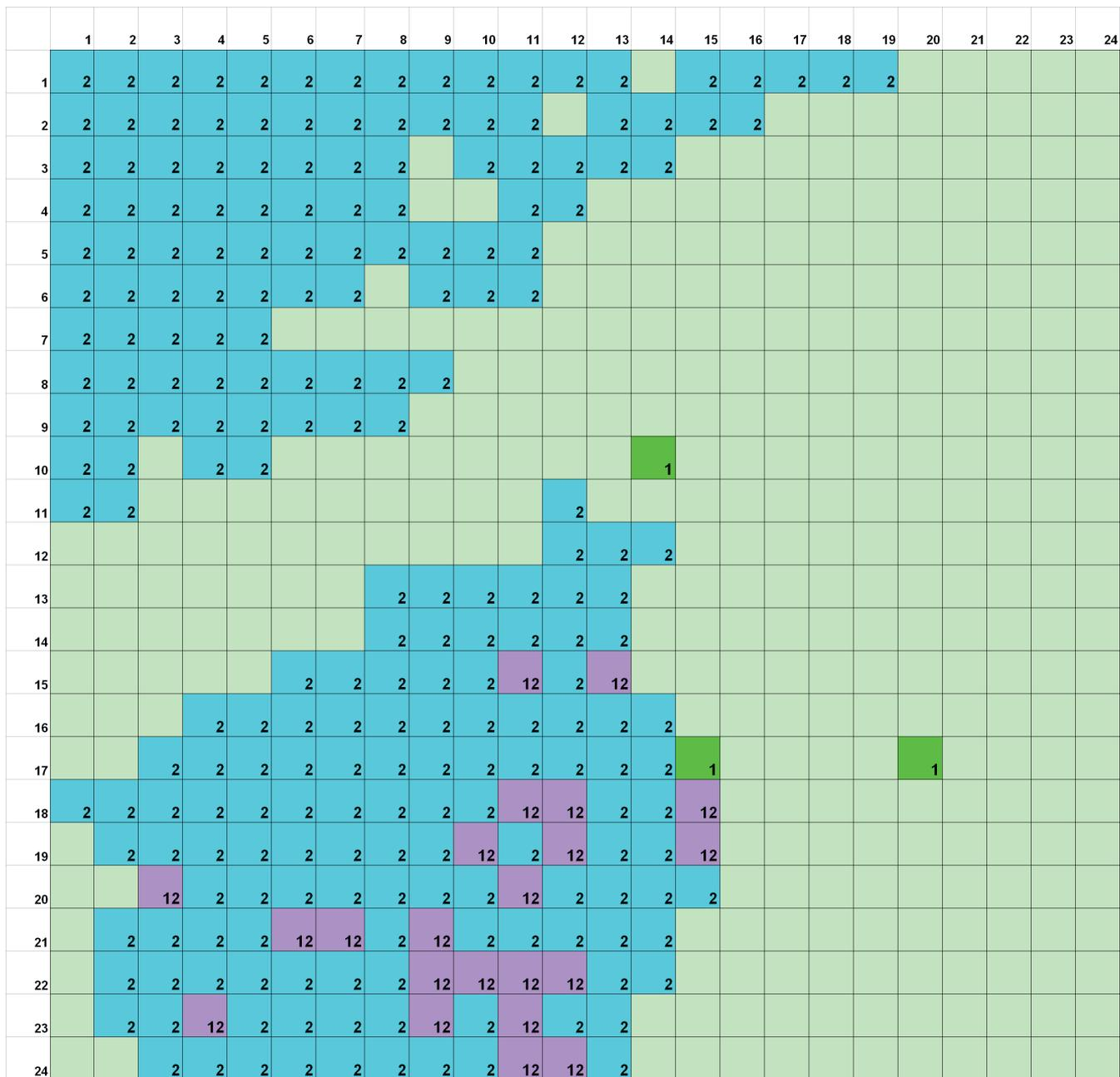
Рис. 4.4.5. Карта попарных сочетаний признаков. Ярко-зеленый (1) — признак наличия проявлений олова. Синий (2) — мощность земной коры  $\geq 40$  км. Фиолетовый (12) — сочетание обоих признаков.
