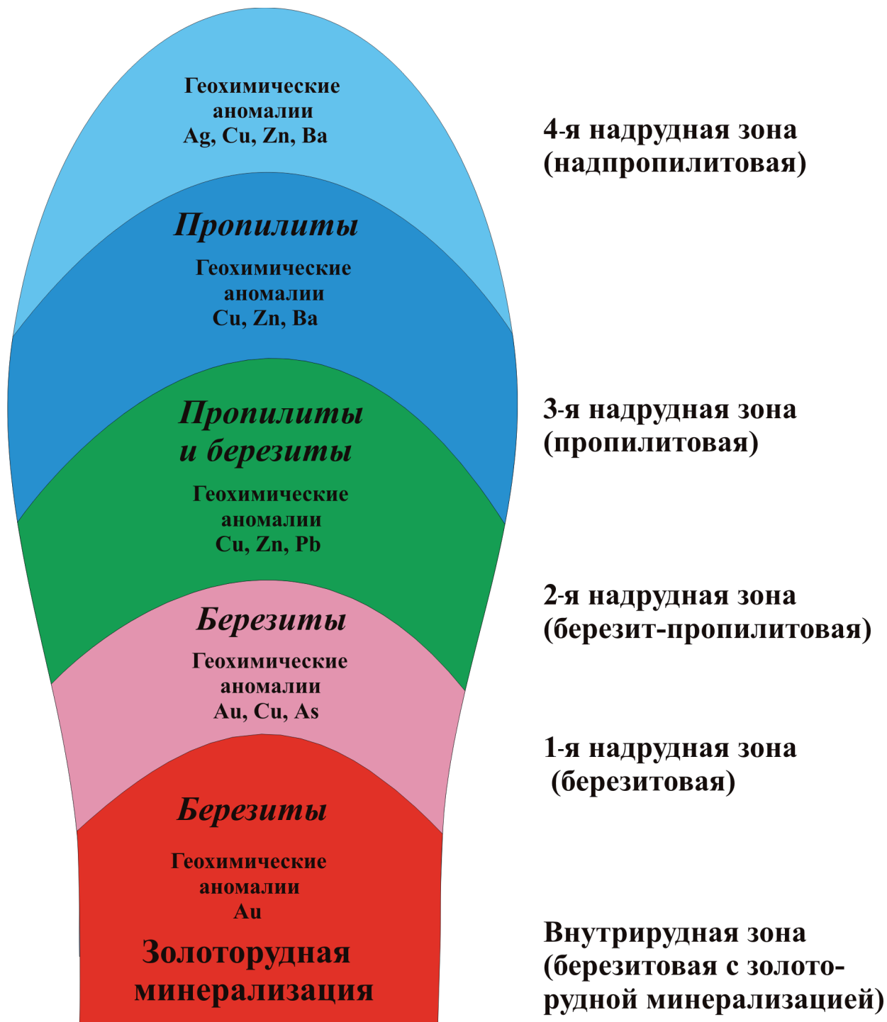
Рис. 4.1.3. Модель зональности золоторудных месторождений березитового типа.
