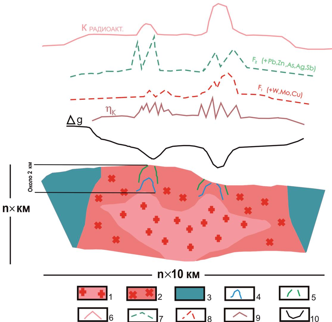
**Рис. 3.5. Модель рудного узла молибденитовой калишпатолит-березитовой формации. Составил М. Л. Сахновский.**
