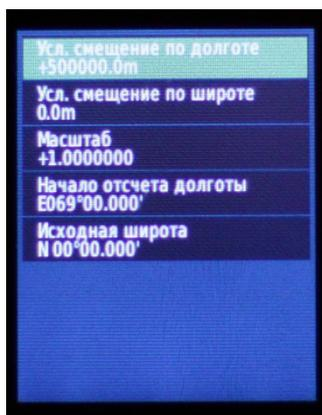
Рис. 4 Вид окна настроек навигатора параметров «Произвольной сетки» («UTM»).
