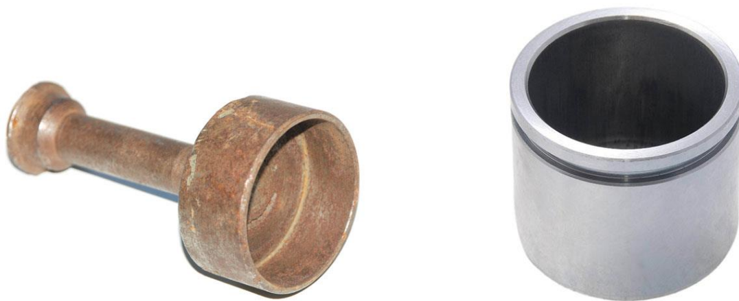
Рис. 8. Специальная насадка для забивания труб в породу (слева), вместо которой можно использовать поршень тормозного суппорта от автомобиля (справа).
