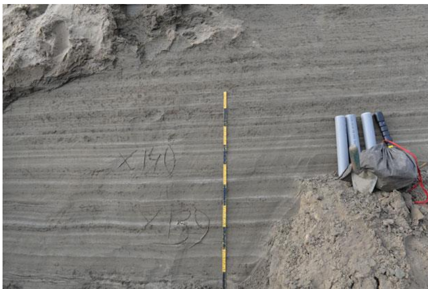
Рис. 10. На расчищенной стенке необходимо обозначить место отбора, номер образца, сфотографировать и измерить высоту.
