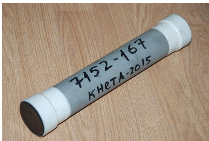
Рис. 13. Правильно отобранный образец для ОСЛ-датирования (слева). Фольгированный изнутри «дой-пак» с тройным замком типа «zip-lock» (справа)
