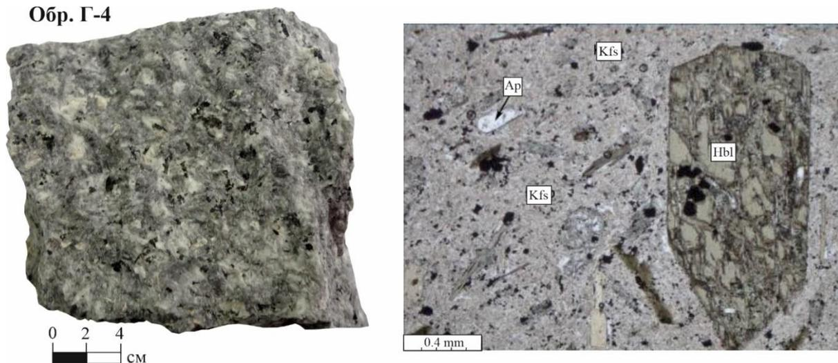
Рис. 3.7 Изображение порфировидного сиенита с микрофотографией шлифа (с анализатором).
